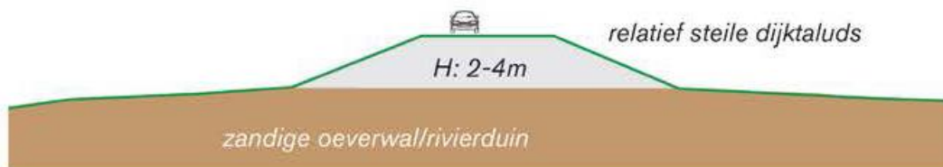
Afbeelding 3.4 Kenmerkend profiel van de Sallandse IJsseldijk [Uit 'Ruimtelijk Perspectief dijken in Overijssel' in Bosch Slabbers, 2017]
