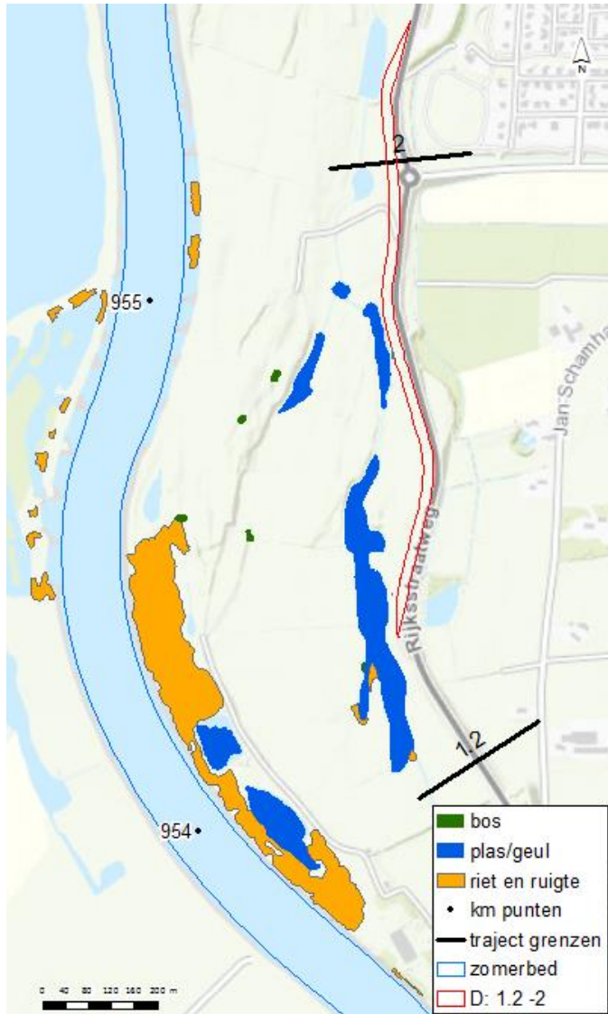
Afbeelding 6.1 Kaart met de rivierwaartse as-verschuiving voor alternatief D en vegetatieruwheden voor plassen, bossen en riet en ruigtes
