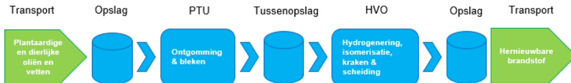
Figuur 3-2: Schematisch overzicht beoogde logistieke proces
