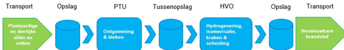
Figuur 3-3: Schematisch overzicht beoogde logistieke proces
