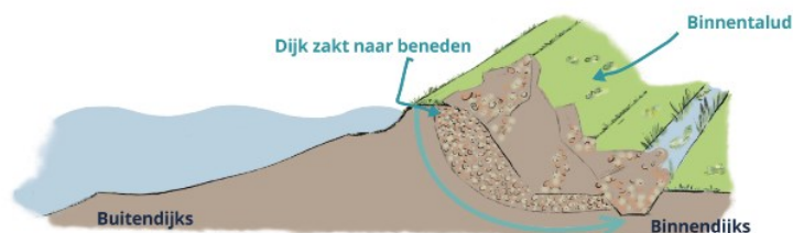
Figuur 3-2 Weergave faalmechanisme stabiliteit binnendijks
