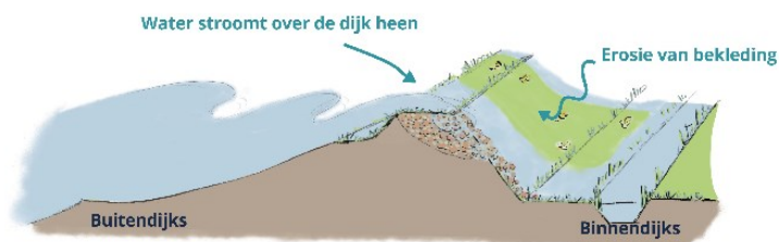
Figuur 3-1 Weergave faalmechanisme hoogte
