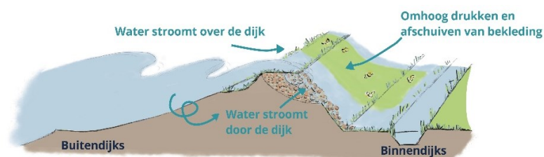
Figuur 3-3 Weergave faalmechanisme afschuiven binnendijks
