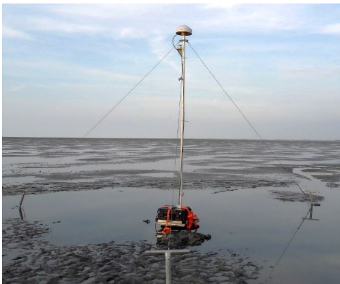
Figuur 7: Meetopstelling jaarlijkse GNSS monitoring
