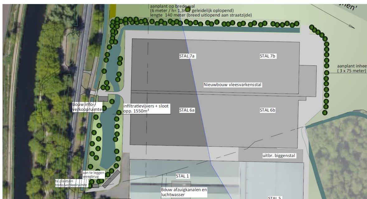
Figuur 27: opvangvoorzieningen hemelwater (bron VanWestreenen Adviseurs)
