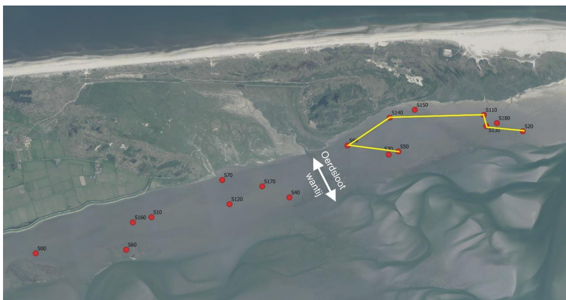
Figuur 4.8 locatie van de spijkermetingen. Spijkers waar de daling van de diepe bodem groter is dan de sedimentatie aangegeven in geel. Overgenomen uit Krol (2020)
