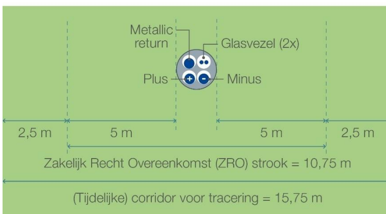
Figuur 1-22 Kabelconfiguratie en ruimtebeslag boring op land
