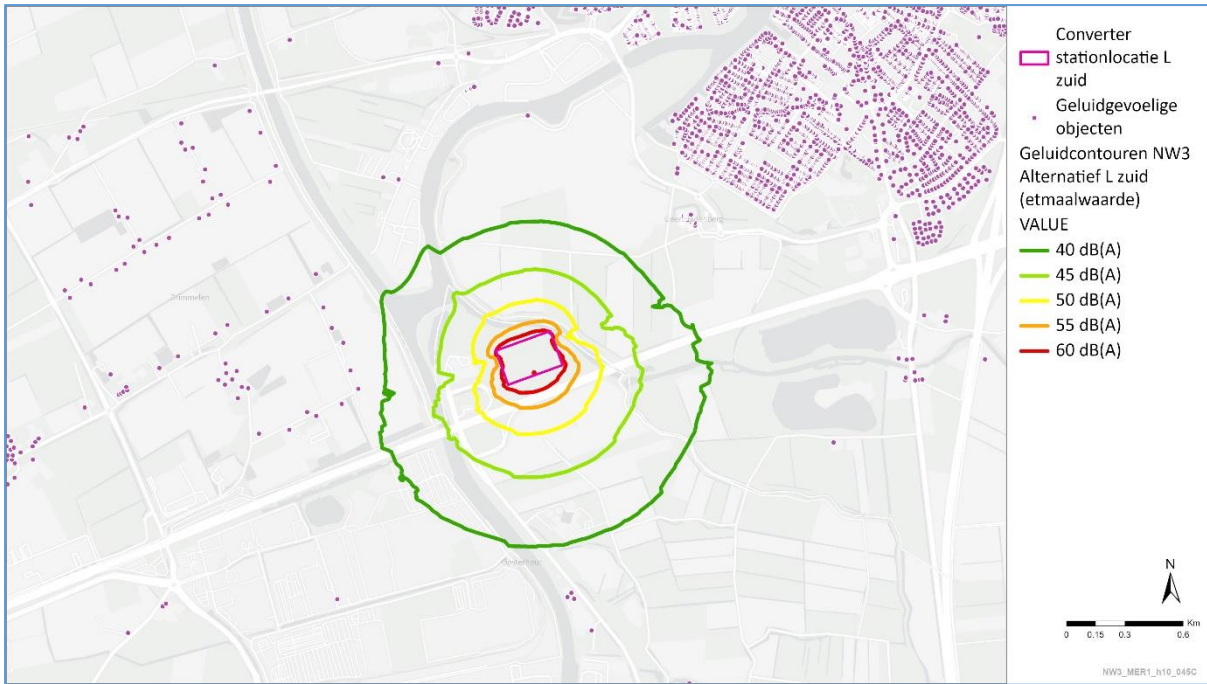
Figuur 10-58 Geluidcontouren ( L_{etmaal} ) vanwege converterstation locatie Stortplaats de Hillen exclusief een toeslag voor tonaal geluid
