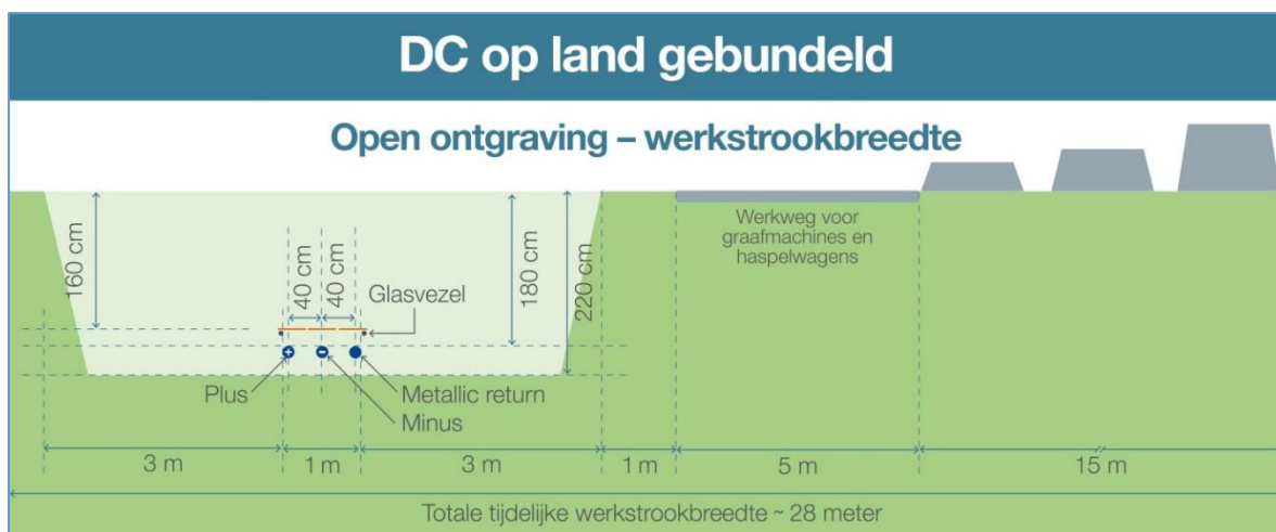
Figuur 1-20 Totale werkerrein bij open ontgraving kabeltracé Net op zee Nederwiek 3
