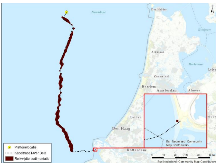
Figuur 4-3 Gebieden waar de sedimentatie per dag boven de grens van 1cm per maand (0,33 mm/dag) uitkomt.
