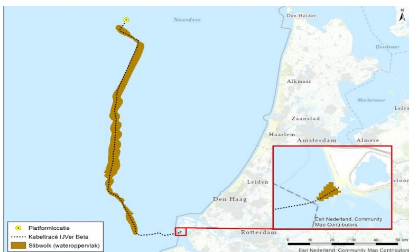
Figuur 4-2 Gebied tot waar de slibwolk ( > 2 mg/l) aan het wateroppervlak maximaal reikt ten gevolge van de werkzaamheden
