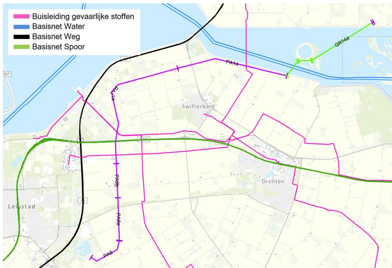
Figuur 6.3 Aanwezige buisleidingen en transportroutes gevaarlijke stoffen, in combinatie met onderzoeksalternatief Noord-Paars-2 (de paarse en lichtgroene lijn met de aanduidingen van de deeltracés erin)
