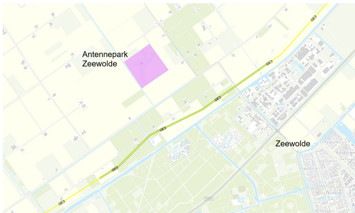
Figuur 8.10 Gedeelte van GE3 waar mogelijk portalen nodig zijn in verband met het antennepark Zeewolde
