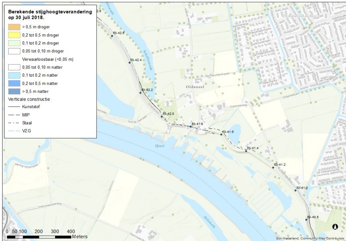
Bijlage afbeelding 45 Resultaten van geohydrologische effecten berekend voor km 40.8 – 42.4, situatie met laagwater gelijk aan 30 juli 2018.
