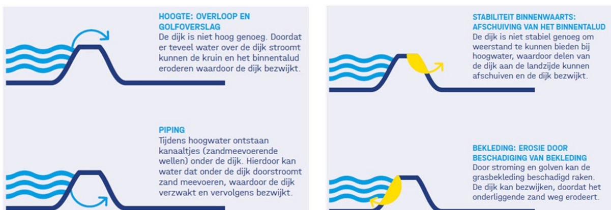
Afbeelding 2.1 Toelichting belangrijkste faalmechanismen voor IJsselwerken
