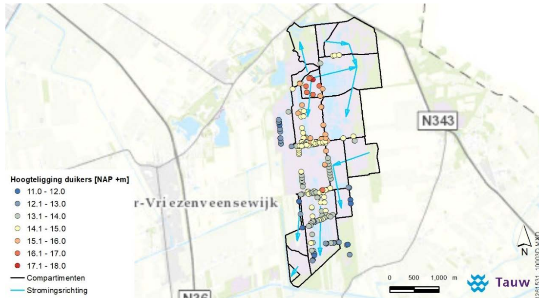
Figuur 2.14 – Gemeten hoogteligging van duikers (2017) en compartimenten incl. stromingsrichting
