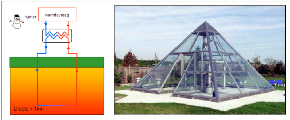
Figuur 4.1: schematische weergave geothermisch systeem en foto bovengrondse installatie
