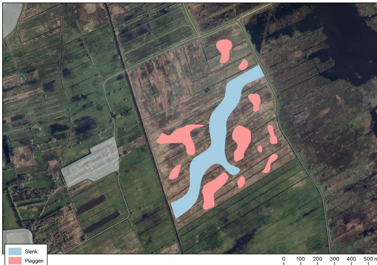
Figuur 7.2: Locatie van plagwerkzaamheden en de te graven slenk (indicatief)
