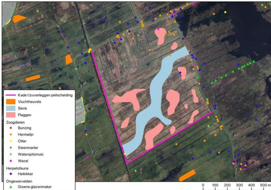
Figuur 7.8: Aan te leggen kades die nodig zijn voor het verleggen van de peilscheiding (roze lijn), locatie plagwerkzaamheden en slenk en de beschermde soorten die in de nabijheid daarvan voorkomen (bron: Deelrapport Natuur, Koolstra Advies)
