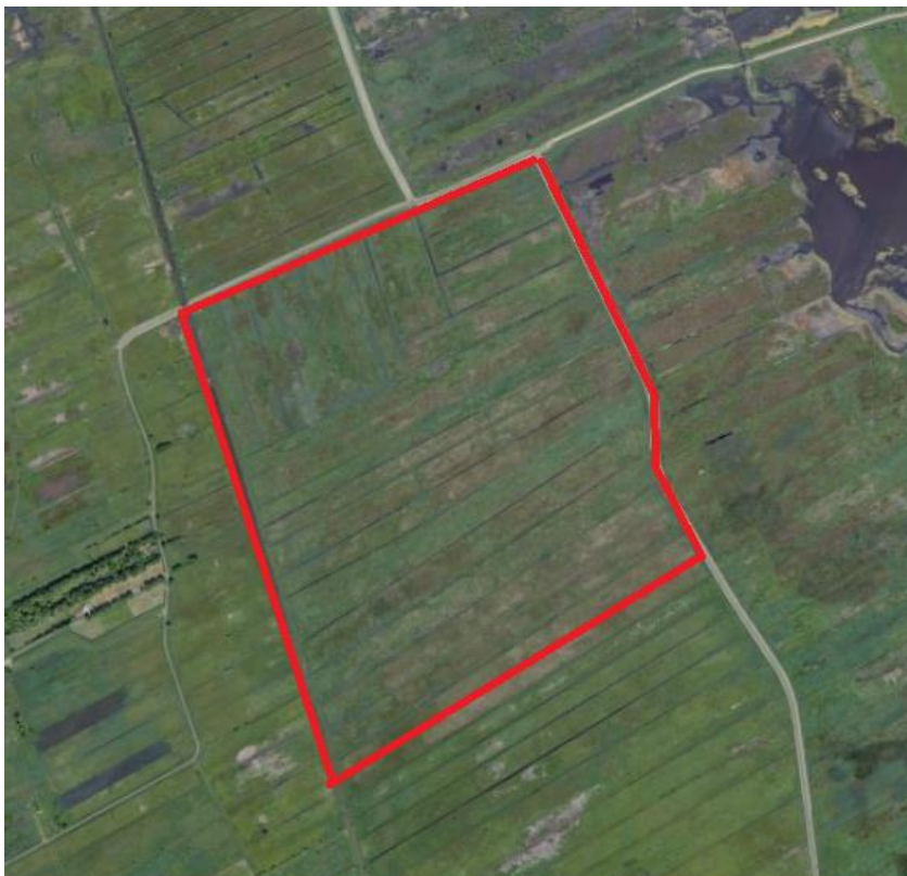
Figuur 2 In rood kader het gebied weergegeven waar de peilverhoging van -0,70 m NAP naar -0,50 m NAP is beoogd
