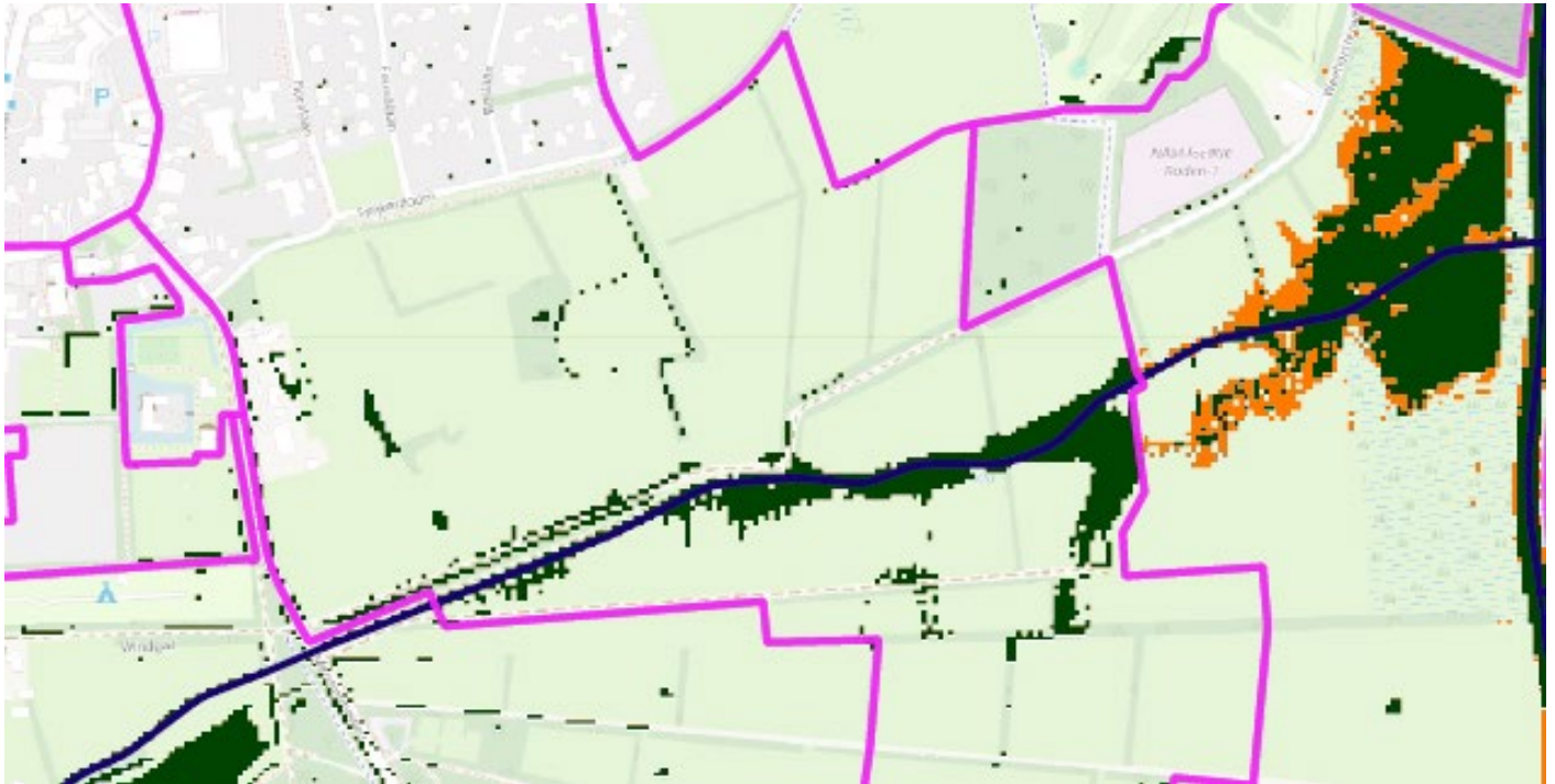
Figuur 44: Extra inundatie als gevolg van Optimalisatie Onlanden (oranje). Extra inundatie treedt op rondom de Steenbergerloop
