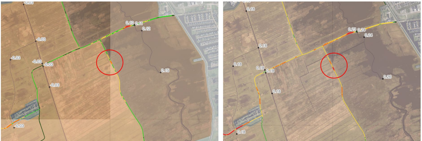
Figuur 28: Drooglegging van de Drentsedijk in de autonome situatie (links) en in het voorkeursalternatief (rechts)
