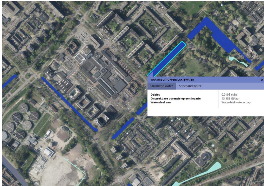
Figuur 4.53 Thermische potentie wateren rondom Overvecht
