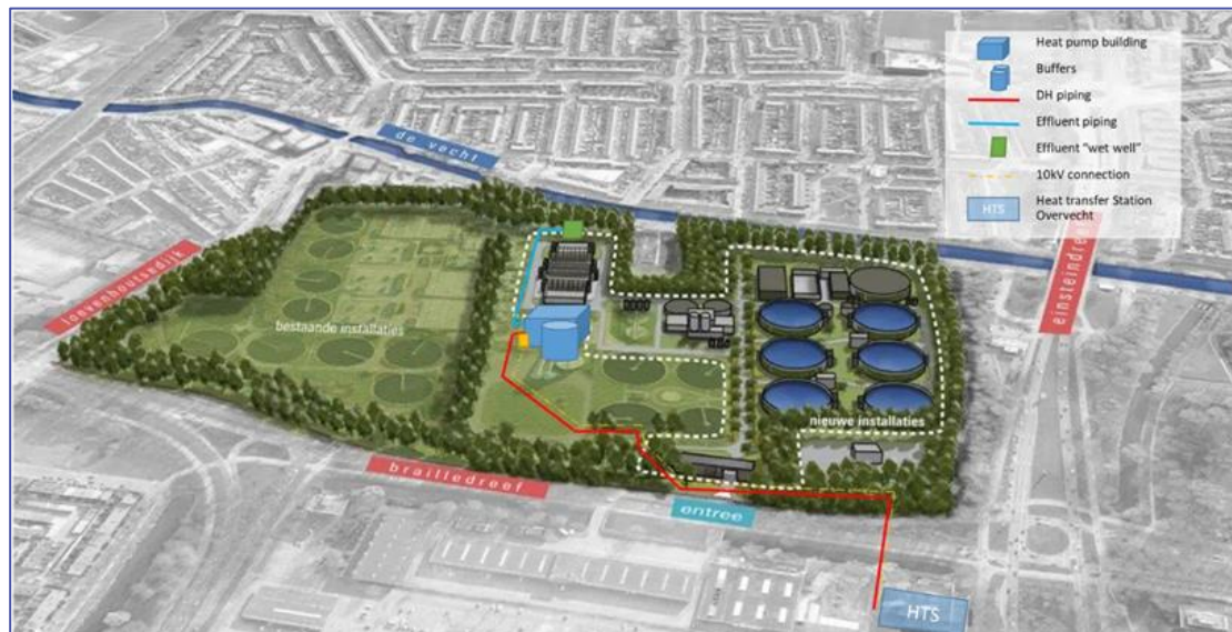
Figuur 4.40 Plaatsing warmtepomp RWZI Utrecht. (Bron: Eneco 22 )
