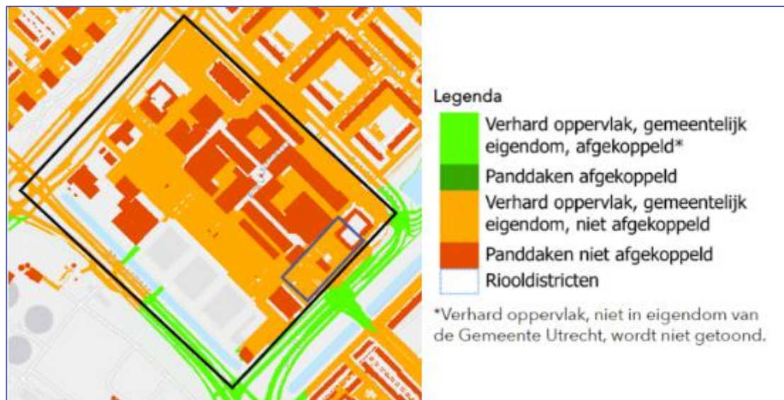
Figuur 4.32 Overzicht afgekoppeld oppervlak in het plangebied (zwarte vlak). Het paarse vierkant is wél afgekoppeld, in tegenstelling tot wat kaartmateriaal suggereert. (Bron: Quickscan Duurzaamheid Overvecht Centrum, gemeente Utrecht)
